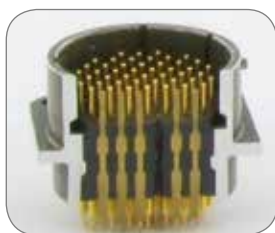
PCB receptacle cross section Coupe d'embase PCB
